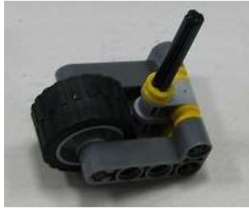
Figura 37. Rueda loca rígida.
