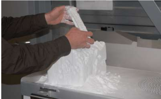
Figura 19. Impresión 3D de sinterización selectiva por láser.
