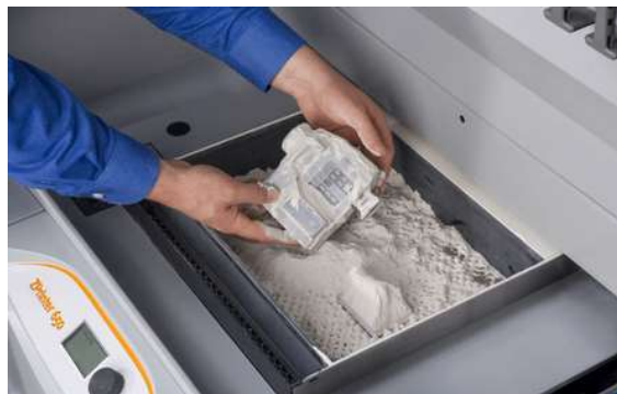
Figura 20. Impresoras 3D por inyección.
