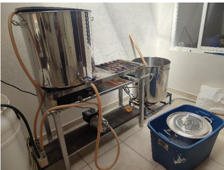
Figura 4. Enfriamiento del mosto.
