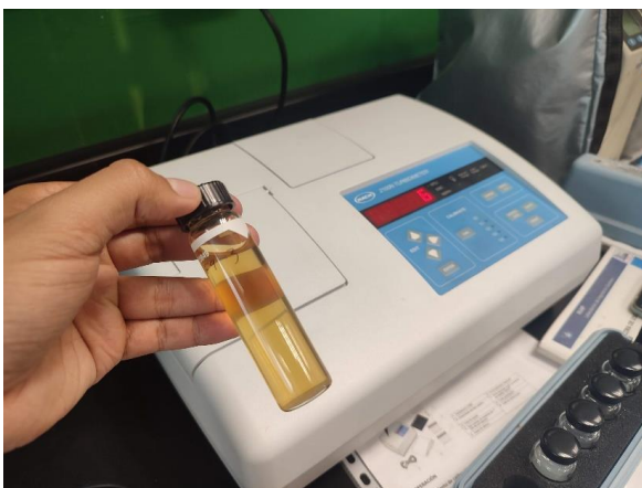
Figura 8. Determinación de turbidez en la cerveza.
